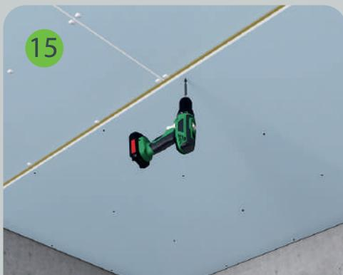
Гипсокартон Gipsolon монтируется совместно с мембраной и крепится к профилю без зазоров между листами саморезами SoundGuard XTN 3,9x41. Расход составляет не менее 17 шт./м<sup>2</sup>. Шляпки саморезов слегка утапливаются.
