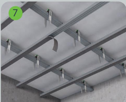
Направляющие и потолочные профили проклеиваются демпферной лентой SoundGuard ВиброЛента.
