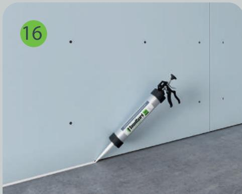
Между торцами листов гипсокартона и поверхностями пола, стен и потолка остается зазор 3 – 5 мм, который впоследствии заполняется виброакустическим герметиком SoundGuard Seal.
